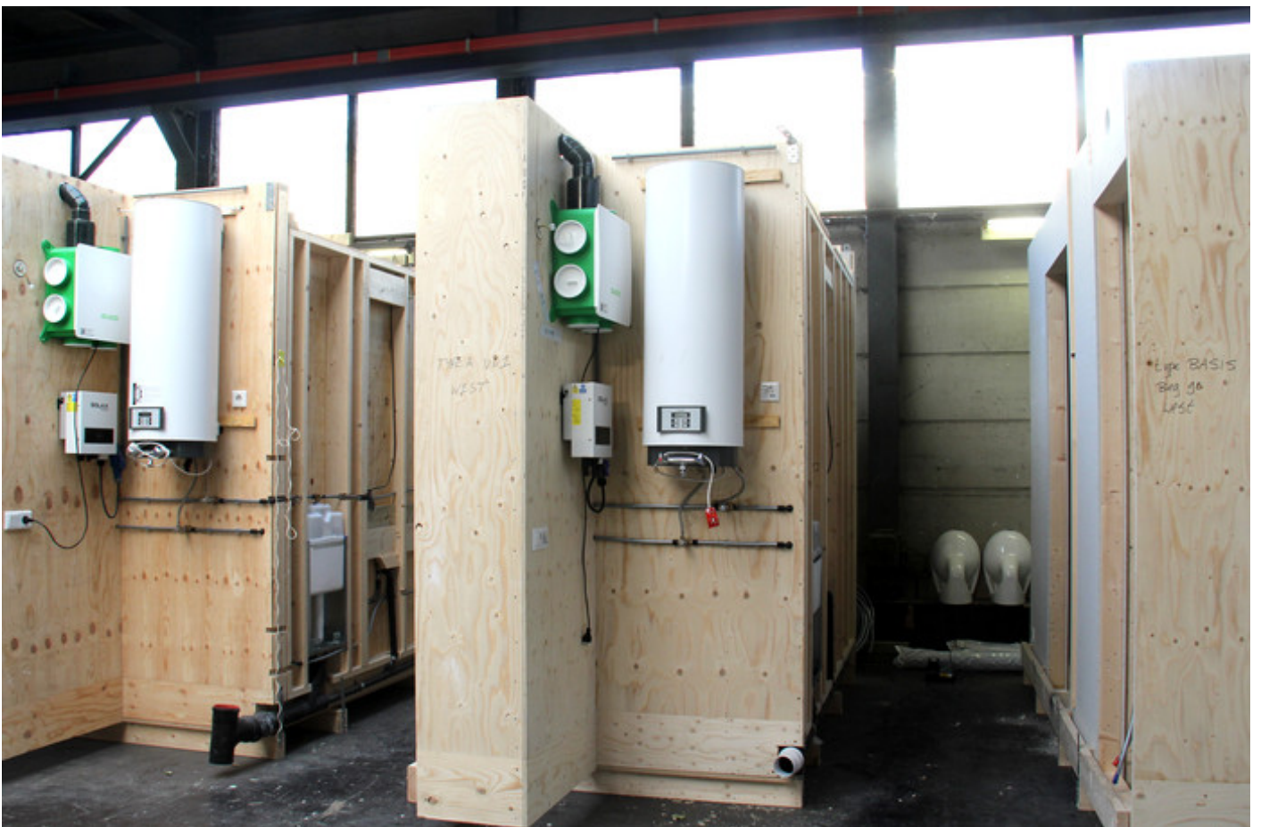
▲ De houten flexwoningen van Sint Trudo, die aan de Quinten Matsyslaan in Eindhoven komen te staan, worden bij timmerfabriek Houkesloot (onderdeel van Friso Bouwgroep BV) in Sneek gebouwd. © Friso BV/Sint Trudo
